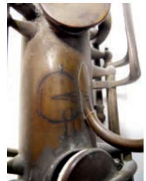
[167] Detail des Alto-Saxophons in F der Sammlung Burri, vermutlich der Prototyp dieses Modells: Die gis-Klappe wurde vorne angezeichnet, aber hinten angebracht. Gut erkennbar sind auch die nicht verarbeiteten Lötstellen.
